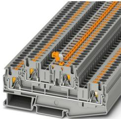
Borna interrumpible por cuchilla, tensión nominal: 500 V, corriente nominal: 28 A, 1er piso, tipo de conexión: Conexión push-in, Sección de dimensionamiento: 4 mm<sup>2</sup>, sección: 0,2 mm<sup>2</sup> - 6 mm<sup>2</sup>, 2. Piso, tipo de conexión: Conexión push-in, Sección de dimensionamiento: 4 mm<sup>2</sup>, sección: 0,2 mm<sup>2</sup> - 6 mm<sup>2</sup>, montaje: NS 35/7,5, NS 35/15, color: gris
