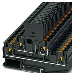
Borne de carril para fusible, tipo de fusible: Vidrio/cerámica/..., tipo de fusible: G/5 x 20, tensión nominal: 24 V, corriente nominal: 28 A, tipo de conexión: Conexión push-in, 1er piso, Sección de dimensionamiento: 4 mm<sup>2</sup>, sección: 0,2 mm<sup>2</sup>- 6 mm<sup>2</sup>, tipo de conexión: Conexión push-in, 2. Piso, Sección de dimensionamiento: 4 mm<sup>2</sup>, sección: 0,2 mm<sup>2</sup>- 6 mm<sup>2</sup>, clase de montaje: NS 35/7,5, NS 35/15, color: negro
