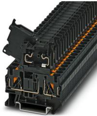
Borne de carril para fusible, tipo de fusible: Vidrio/cerámica/..., tipo de fusible: G/5 x 20, tensión nominal: 500 V, corriente nominal: 6,3 A, número de polos: 1, tipo de conexión: Conexión push-in, Sección de dimensionamiento: 4 mm<sup>2</sup>, sección: 0,2 mm<sup>2</sup>- 6 mm<sup>2</sup>, clase de montaje: NS 35/7,5, NS 35/15, color: negro
