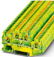
Borne de doble piso conductor de protección, tipo de conexión: Conexión push-in, 1er y 2º piso, sección: 0,2 mm<sup>2</sup> - 6 mm<sup>2</sup>, clase de montaje: NS 35/7,5, NS 35/15, color: amarillo-verde
