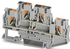
Borna de doble piso, con empalmadores de potencial, tensión nominal: 500 V, corriente nominal: 30 A, tipo de conexión: Conexión push-in, 1er y 2º piso, Sección de dimensionamiento: 4 mm<sup>2</sup>, sección: 0,2 mm<sup>2</sup> - 6 mm<sup>2</sup>, clase de montaje: NS 35/7,5, NS 35/15, color: gris
