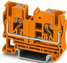
Borne de paso, tensión nominal: 1000 V, corriente nominal: 41 A, número de conexiones: 2, tipo de conexión: Conexión push-in, Sección de dimensionamiento: 6 mm<sup>2</sup>, sección: 0,5 mm<sup>2</sup> - 10 mm<sup>2</sup>, clase de montaje: NS 35/7,5, NS 35/15, color: naranja
