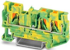
Borna de tierra, número de conexiones: 3, tipo de conexión: Conexión push-in, Sección de dimensionamiento: 4 mm<sup>2</sup>, sección: 0,2 mm<sup>2</sup> - 6 mm<sup>2</sup>, clase de montaje: NS 35/7,5, NS 35/15, color: amarillo-verde
