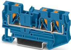
Borne de paso, tensión nominal: 800 V, corriente nominal: 32 A, número de conexiones: 3, tipo de conexión: Conexión push-in, Sección de dimensionamiento: 4 mm<sup>2</sup>, sección: 0,2 mm<sup>2</sup> - 6 mm<sup>2</sup>, clase de montaje: NS 35/7,5, NS 35/15, color: azul
