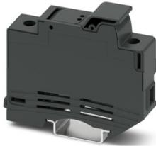
Soporte para fusibles, tipo de fusible: Vidrio/cerámica/..., tipo de fusible: gPV 10,3 x 38 mm según 60269-6, tensión nominal: 1000 V DC, corriente nominal: 30 A, tipo de conexión: Conexión por tornillo, Sección de dimensionamiento: 16 mm<sup>2</sup>, sección: 1 mm<sup>2</sup>- 16 mm<sup>2</sup>, clase de montaje: NS 35/7,5, NS 35/15, color: negro
