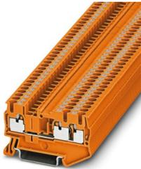
Borne de paso, tensión nominal: 800 V, corriente nominal: 24 A, número de conexiones: 3, tipo de conexión: Conexión push-in, Sección de dimensionamiento: 2,5 mm<sup>2</sup>, sección: 0,14 mm<sup>2</sup> - 4 mm<sup>2</sup>, clase de montaje: NS 35/7,5, NS 35/15, color: naranja
