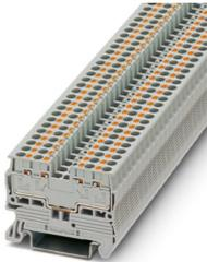
Borne de paso, tensión nominal: 500 V, corriente nominal: 17,5 A, número de conexiones: 4, tipo de conexión: Conexión push-in, Sección de dimensionamiento: 2,5 mm<sup>2</sup>, sección: 0,14 mm<sup>2</sup> - 4 mm<sup>2</sup>, clase de montaje: NS 35/7,5, NS 35/15, color: gris
