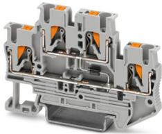
Borne para componentes, con diodo integrado 1N4007, corriente nominal: 0,5 A, número de conexiones: 4, tipo de conexión: Conexión push-in, Sección de dimensionamiento: 2,5 mm<sup>2</sup>, 1er y 2º piso, sección: 0,14 mm<sup>2</sup> - 4 mm<sup>2</sup>, clase de montaje: NS 35/7,5, NS 35/15, color: gris
