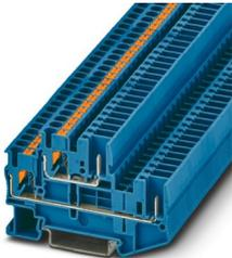
Borna de doble piso, La corriente y la tensión son determinadas por el conector empleado., tensión nominal: 500 V, corriente nominal: 22 A, tipo de conexión: Conexión push-in / conexión enchufable, 1er y 2º piso, Sección de dimensionamiento: 2,5 mm<sup>2</sup>, sección: 0,14 mm<sup>2</sup> - 4 mm<sup>2</sup>, clase de montaje: NS 35/7,5, NS 35/15, color: azul
