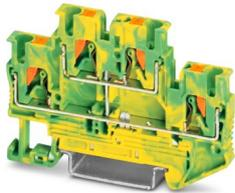
Borne de doble piso conductor de protección, número de conexiones: 4, tipo de conexión: Conexión push-in, 1er y 2º piso, Sección de dimensionamiento: 2,5 mm<sup>2</sup>, sección: 0,14 mm<sup>2</sup> - 4 mm<sup>2</sup>, clase de montaje: NS 35/7,5, NS 35/15, color: amarillo-verde
