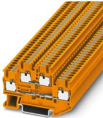
Borna de doble piso, tensión nominal: 500 V, corriente nominal: 22 A, tipo de conexión: Conexión push-in, 1er y 2º piso, Sección de dimensionamiento: 2,5 mm<sup>2</sup>, sección: 0,14 mm<sup>2</sup> - 4 mm<sup>2</sup>, clase de montaje: NS 35/7,5, NS 35/15, color: naranja
