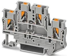
Borna de doble piso, tensión nominal: 500 V, corriente nominal: 22 A, tipo de conexión: Conexión push-in, 1er y 2º piso, Sección de dimensionamiento: 2,5 mm<sup>2</sup>, sección: 0,14 mm<sup>2</sup> - 4 mm<sup>2</sup>, clase de montaje: NS 35/7,5, NS 35/15, color: gris
