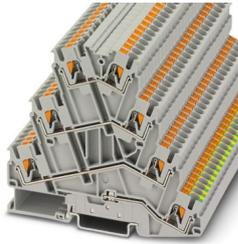
Borne para motores, cuatro pisos, tipo de conexión: conexión push-in, sección transversal: 0,14 mm<sup>2</sup> - 4 mm<sup>2</sup>, AWG: 26 - 12, ancho: 5,2 mm, altura: 91,1 mm, color: gris, tipo de montaje: NS 35/7,5, NS 35/15
