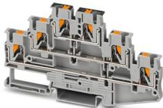
Borne multipiso, con empalmadores de potencial, tensión nominal: 500 V, corriente nominal: 20 A, número de conexiones: 6, tipo de conexión: Conexión push-in, Sección de dimensionamiento: 2,5 mm<sup>2</sup>, 1., 2. y 3er piso, sección: 0,14 mm<sup>2</sup> - 4 mm<sup>2</sup>, clase de montaje: NS 35/7,5, NS 35/15, color: gris
