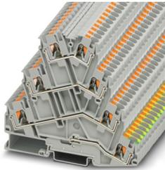
Borne para motores, cuatro pisos, tipo de conexión: conexión push-in, sección transversal: 0,2 mm<sup>2</sup> - 6 mm<sup>2</sup>, AWG: 24 - 10, ancho: 6,2 mm, altura: 95,4 mm, color: gris, tipo de montaje: NS 35/7,5, NS 35/15
