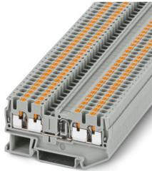
Borne para componentes, con diodo integrado 1N4007, tensión nominal: 800 V, corriente nominal: 0,5 A, número de conexiones: 4, tipo de conexión: Conexión push-in, Sección de dimensionamiento: 2,5 mm<sup>2</sup>, 1er piso, sección: 0,14 mm<sup>2</sup> - 4 mm<sup>2</sup>, clase de montaje: NS 35/7,5, NS 35/15, color: gris
