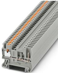
Borne de paso, tensión nominal: 500 V, corriente nominal: 24 A, número de conexiones: 2, tipo de conexión: Conexión push-in / conexión enchufable, Sección de dimensionamiento: 2,5 mm<sup>2</sup>, sección: 0,14 mm<sup>2</sup> - 4 mm<sup>2</sup>, clase de montaje: NS 35/7,5, NS 35/15, color: gris
