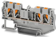
Borne de paso, tensión nominal: 800 V, corriente nominal: 24 A, número de conexiones: 4, tipo de conexión: Conexión push-in, Sección de dimensionamiento: 2,5 mm<sup>2</sup>, sección: 0,14 mm<sup>2</sup> - 4 mm<sup>2</sup>, clase de montaje: NS 35/7,5, NS 35/15, color: gris
