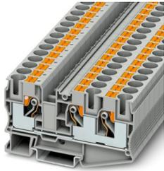
Borne de paso, tensión nominal: 1000 V, corriente nominal: 57 A, número de conexiones: 3, tipo de conexión: Conexión push-in, Sección de dimensionamiento: 10 mm<sup>2</sup>, sección: 0,5 mm<sup>2</sup> - 16 mm<sup>2</sup>, clase de montaje: NS 35/7,5, NS 35/15, color: gris
