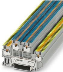
Borne de doble piso conductor de protección, tensión nominal: 500 V, corriente nominal: 16 A, tipo de conexión: Conexión push-in, 1er y 2º piso, Sección de dimensionamiento: 1,5 mm<sup>2</sup>, sección: 0,14 mm<sup>2</sup> - 1,5 mm<sup>2</sup>, clase de montaje: NS 35/7,5, NS 35/15, color: gris
