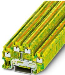
Borne de doble piso conductor de protección, número de conexiones: 4, tipo de conexión: Conexión push-in, 1er y 2º piso, sección: 0,14 mm<sup>2</sup> - 1,5 mm<sup>2</sup>, clase de montaje: NS 35/7,5, NS 35/15, color: amarillo-verde
