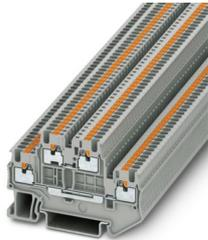
Borna de doble piso, tensión nominal: 500 V, corriente nominal: 16 A, tipo de conexión: Conexión push-in, 1er y 2º piso, Sección de dimensionamiento: 1,5 mm<sup>2</sup>, sección: 0,14 mm<sup>2</sup> - 1,5 mm<sup>2</sup>, clase de montaje: NS 35/7,5, NS 35/15, color: gris
