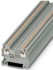
Borne de paso, tensión nominal: 500 V, corriente nominal: 17,5 A, número de conexiones: 2, tipo de conexión: Conexión push-in, Sección de dimensionamiento: 1,5 mm<sup>2</sup>, 1er piso, sección: 0,14 mm<sup>2</sup> - 1,5 mm<sup>2</sup>, clase de montaje: NS 35/7,5, NS 35/15, color: gris
