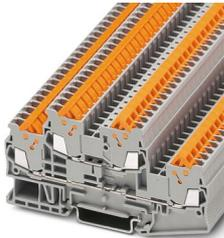
Borna de doble piso, tensión nominal: 500 V, corriente nominal: 17,5 A, tipo de conexión: Conexión rápida, 1er y 2º piso, Sección de dimensionamiento: 1,5 mm<sup>2</sup>, sección: 0,25 mm<sup>2</sup> - 1,5 mm<sup>2</sup>, clase de montaje: NS 35/7,5, NS 35/15, color: gris
