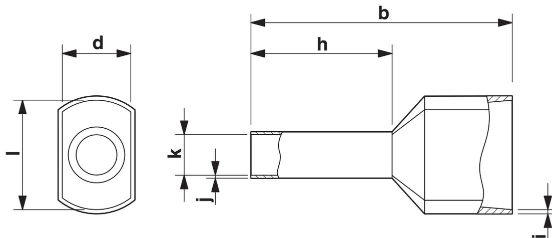
Longitud de la puntera (b), longitud de la zona de contacto (h), dimensión interior del collar aislante (d), diámetro de la puntera (k), grosor del collar aislante (i), grosor de la pared de la puntera (j)
