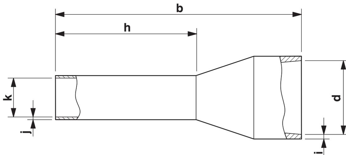
Longitud de la puntera (b), longitud de la zona de contacto (h), dimensión interior del collar aislante (d), diámetro de la puntera (k), grosor del collar aislante (i), grosor de la pared de la puntera (j)
