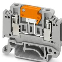
Borna interrumpible por cuchilla, tensión nominal: 400 V, corriente nominal: 16 A, tipo de conexión: Conexión por tornillo, Sección de dimensionamiento: 2,5 mm<sup>2</sup>, sección: 0,2 mm<sup>2</sup> - 4 mm<sup>2</sup>, montaje: NS 35/7,5, NS 35/15, NS 32, color: gris
