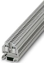
Microborna, tensión nominal: 400 V, corriente nominal: 17,5 A, número de conexiones: 2, tipo de conexión: Conexión por tornillo, Sección de dimensionamiento: 1,5 mm<sup>2</sup>, sección: 0,14 mm<sup>2</sup> - 1,5 mm<sup>2</sup>, clase de montaje: NS 15, color: gris
