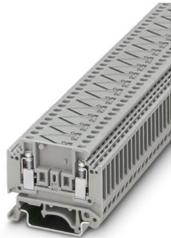
Bornes para termopares, TC tipo B, tensión nominal: 400 V, corriente nominal: 1 A, número de conexiones: 4, número de polos: 2, tipo de conexión: Conexión por tornillo, sección: 0,2 mm<sup>2</sup> - 4 mm<sup>2</sup>, clase de montaje: NS 35/7,5, NS 35/15, NS 32, color: gris
