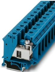
Borna de instalación, tensión nominal: 800 V, corriente nominal: 125 A, Conexión por tornillo, Sección de dimensionamiento: 35 mm<sup>2</sup>, sección: 0,75 mm<sup>2</sup> - 35 mm<sup>2</sup>, clase de montaje: NS 35/7,5, NS 35/15, color: azul
