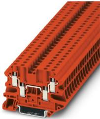
Borne universal de cuatro conductores, tensión nominal: 500 V, corriente nominal: 32 A, número de conexiones: 4, tipo de conexión: Conexión por tornillo, Sección de dimensionamiento: 4 mm<sup>2</sup>, sección: 0,14 mm<sup>2</sup> - 6 mm<sup>2</sup>, clase de montaje: NS 35/7,5, NS 35/15, color: rojo
