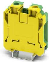
Borna de tierra, número de conexiones: 2, tipo de conexión: Conexión por tornillo, Sección de dimensionamiento: 35 mm<sup>2</sup>, sección: 10 mm<sup>2</sup> - 35 mm<sup>2</sup>, tipo de sujeción: Pie PE con tornillo de fijación, M5, clase de montaje: NS 35/7,5, NS 35/15, color: amarillo-verde
