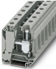
Borne de paso, tensión nominal: 1000 V, corriente nominal: 125 A, número de conexiones: 2, tipo de conexión: Conexión por tornillo, Sección de dimensionamiento: 35 mm<sup>2</sup>, sección: 10 mm<sup>2</sup> - 35 mm<sup>2</sup>, clase de montaje: NS 35/7,5, NS 35/15, color: gris
