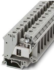
Borna de instalación, tensión nominal: 800 V, corriente nominal: 125 A, Conexión por tornillo, Sección de dimensionamiento: 35 mm<sup>2</sup>, sección: 0,75 mm<sup>2</sup> - 35 mm<sup>2</sup>, clase de montaje: NS 35/7,5, NS 35/15, color: gris
