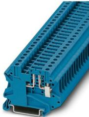
Borna seccionable, La corriente y la tensión son determinadas por el conector empleado., con hembras roscadas para tomas de prueba para alojar clavijas de prueba, tensión nominal: 500 V, Corriente constante térmica  $I_{th}$ : 20 A, tipo de conexión: Conexión por tornillo, Sección de dimensionamiento: 4 mm<sup>2</sup>, sección: 0,14 mm<sup>2</sup> - 6 mm<sup>2</sup>, montaje: NS 35/7,5, NS 35/15, color: azul
