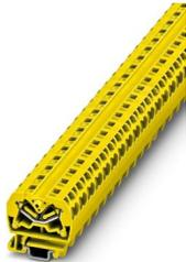
Miniborna de paso, tensión nominal: 800 V, corriente nominal: 24 A, número de conexiones: 4, tipo de conexión: Conexión por resorte, Sección de dimensionamiento: 2,5 mm<sup>2</sup>, 1er piso, sección: 0,08 mm<sup>2</sup> - 4 mm<sup>2</sup>, clase de montaje: NS 15, color: amarillo
