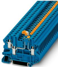
Borna interrumpible por cuchilla, tensión nominal: 500 V, corriente nominal: 20 A, tipo de conexión: Conexión por tornillo, Sección de dimensionamiento: 4 mm<sup>2</sup>, sección: 0,14 mm<sup>2</sup> - 6 mm<sup>2</sup>, montaje: NS 35/7,5, NS 35/15, color: azul
