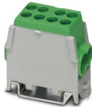
Módulo de ramificación de cable principal, tensión nominal: 400 V, corriente nominal: 101 A, número de conexiones: 4, número de polos: 1, tipo de conexión: Conexión por tornillo, Sección de dimensionamiento: 25 mm<sup>2</sup>, 1er piso, sección: 1,5 mm<sup>2</sup> - 25 mm<sup>2</sup>, Conexión por tornillo, 2. Piso, sección: 1,5 mm<sup>2</sup> - 16 mm<sup>2</sup>, clase de montaje: NS 35/7,5, NS 35/15, color: verde
