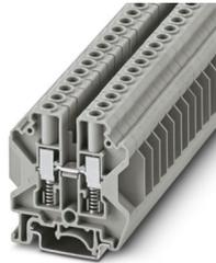
Borne de paso, tensión nominal: 1000 V, corriente nominal: 41 A, número de conexiones: 2, tipo de conexión: Conexión por tornillo con soporte para resorte, Sección de dimensionamiento: 6 mm<sup>2</sup>, 1er piso, sección: 0,2 mm<sup>2</sup> - 10 mm<sup>2</sup>, clase de montaje: NS 35/7,5, NS 35/15, NS 32, color: gris
