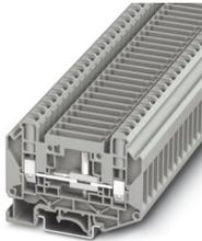
Borne interrump. para circ. medida, tensión nominal: 1000 V, corriente nominal: 41 A, tipo de conexión: Conexión por tornillo, 1er piso, Sección de dimensionamiento: 6 mm<sup>2</sup>, sección: 0,2 mm<sup>2</sup> - 10 mm<sup>2</sup>, clase de montaje: NS 35/7,5, NS 35/15, NS 32, color: gris
