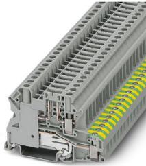
Borna de tierra, La corriente y la tensión son determinadas por el conector empleado., tensión nominal: 500 V, corriente nominal: 20 A, tipo de conexión: Conexión por tornillo, Sección de dimensionamiento: 2,5 mm<sup>2</sup>, sección: 0,14 mm<sup>2</sup> - 6 mm<sup>2</sup>, montaje: NS 35/7,5, NS 35/15, color: gris
