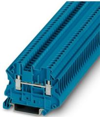
Borne de paso, tensión nominal: 800 V, corriente nominal: 24 A, número de conexiones: 2, tipo de conexión: Conexión por tornillo, Sección de dimensionamiento: 2,5 mm<sup>2</sup>, sección: 0,14 mm<sup>2</sup> - 4 mm<sup>2</sup>, clase de montaje: NS 35/7,5, NS 35/15, color: azul
