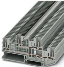
Borna de doble piso, La corriente y la tensión son determinadas por el conector empleado., con empalmadores de potencial, tensión nominal: 500 V, corriente nominal: 22 A, tipo de conexión: Conexión enchufable, 1. Y 2º piso, conexión a la izquierda, Sección de dimensionamiento: 2,5 mm<sup>2</sup>, sección: 0,08 mm<sup>2</sup> - 4 mm<sup>2</sup>, clase de montaje: NS 35/15, NS 35/7,5, color: gris
