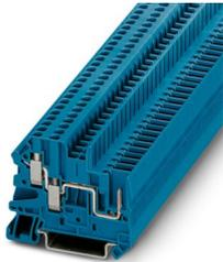
Borne de paso, tensión nominal: 500 V, corriente nominal: 24 A, número de conexiones: 3, número de polos: 1, tipo de conexión: Conexión por tornillo / conexión enchufable, Sección de dimensionamiento: 2,5 mm<sup>2</sup>, sección: 0,14 mm<sup>2</sup> - 4 mm<sup>2</sup>, clase de montaje: NS 35/7,5, NS 35/15, color: azul
