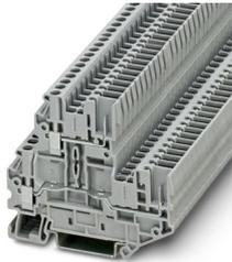
Borna de doble piso, La corriente y la tensión son determinadas por el conector empleado., tensión nominal: 500 V, corriente nominal: 24 A, tipo de conexión: Conexión por tornillo / conexión enchufable, Sección de dimensionamiento: 2,5 mm<sup>2</sup>, sección: 0,14 mm<sup>2</sup> - 4 mm<sup>2</sup>, clase de montaje: NS 35/7,5, NS 35/15, color: gris
