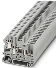
Borne de paso, tensión nominal: 500 V, corriente nominal: 32 A, número de conexiones: 3, número de polos: 1, tipo de conexión: Conexión por tornillo / conexión enchufable, Sección de dimensionamiento: 4 mm<sup>2</sup>, sección: 0,14 mm<sup>2</sup> - 6 mm<sup>2</sup>, clase de montaje: NS 35/7,5, NS 35/15, color: gris
